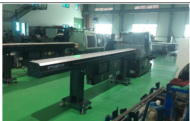
Lắp đặt máy tiện CNC Swiss type hãng Tsugami Nhật Bản, tháng 6/2019
