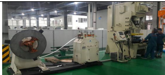
Sản xuất và ghép nối 03 bộ cáp phôi tự động với máy dập cũ của khách hàng – 4/2021
