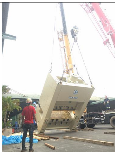
LẮP ĐẶT MÁY DẬP 400 TẤN, 2 TRỤC KHUYU, LINK DRIVE – 6/2019
