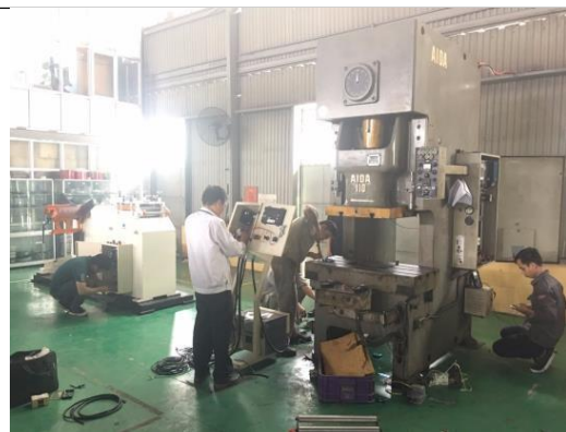
SẢN XUẤT BỘ CÁP PHÔI VÀ KẾT NỐI VỚI MÁY AIDA 110 TẤN – Tháng 9/2018
