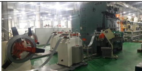
Sản xuất và ghép nối 03 bộ cáp phôi tự động với máy dập cũ của khách hàng – 4/2021
