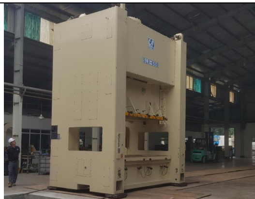
CUNG CẤP, LẮP ĐẶT MÁY DẬP 600 TẤN, 2 TRỤC KHUYỬ, LINK DRIVE 9/2019
