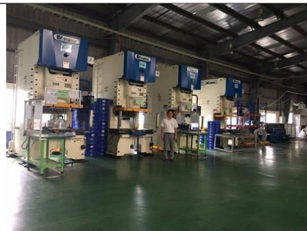
THỰC HIỆN DỊCH VỤ NÂNG HẠ & LẮP ĐẶT 03 MÁY 350 TẤN 2 TRỤC KHUYỬ VÀ 04 MÁY 200 TẤN 1 TRỤC KHUYỬ- Tháng 3/2018
