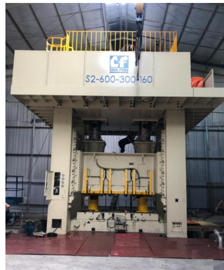
GIAO HÀNG VÀ LẮP ĐẶT MÁY DẬP GEAR ECCETRIC S2-600T (5/2021) – NẶNG 215 TẤN
