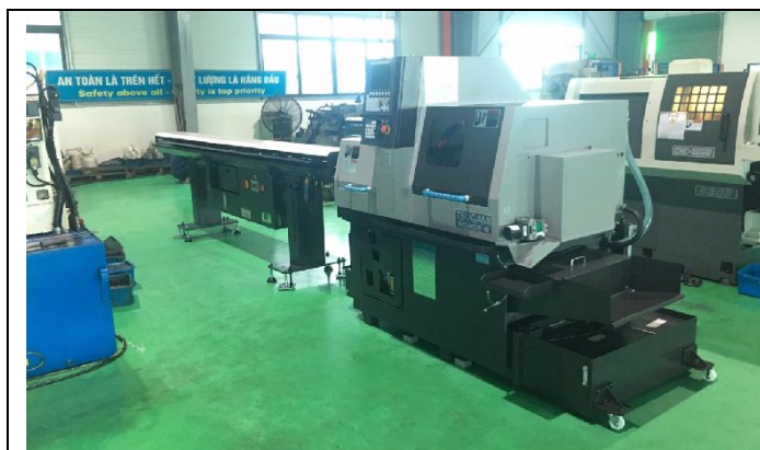
Lắp đặt máy tiện CNC Swiss type hãng Tsugami Nhật Bản, tháng 6/2019
