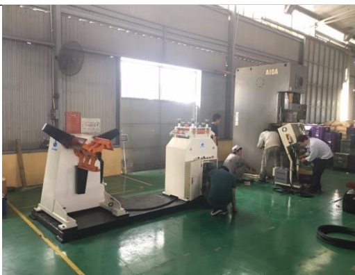
SẢN XUẤT BỘ CÁP PHÔI VÀ KẾT NỐI VỚI MÁY AIDA 110 TẤN – Tháng 9/2018
