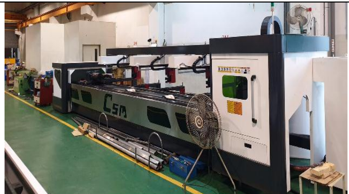
Máy cắt ống Laser CNC LS150 – hãng CSM, tháng 7/2019
