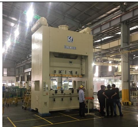
LẮP ĐẶT MÁY DẬP 400 TẤN, 2 TRỤC KHUYU, LINK DRIVE – 6/2019
