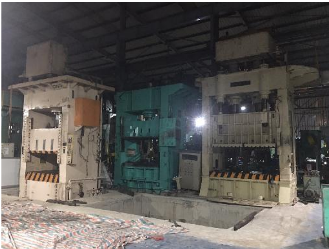
CUNG CẤP VÀ LẮP ĐẶT 02 MÁY ÉP SONG ĐỘNG NHẬT CŨ 400T & 500T – 7/2019
