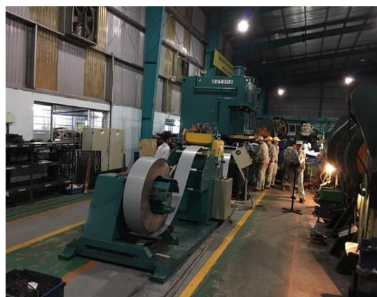
LẮP ĐẶT MÁY DẬP CẤP PHÔI TỰ ĐỘNG 150T HAI TRỤC KHUYỬU – Tháng 8/2017
