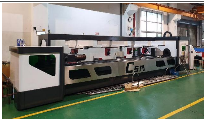
Máy cắt ống Laser CNC LS150 – hãng CSM, tháng 7/2019
